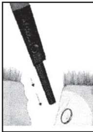
Рис. 3. Пінпойтер для визначення контурів металу
