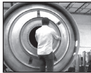
Рис. 3. Обстеження ободу рудного транспорту
