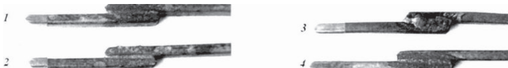
Рис. 1. Загальний вигляд паяних з'єднань статорних обмоток електродвигуна
