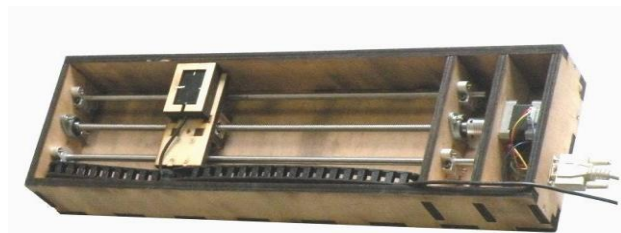
Рентген-телевизионный детектор с внешними размерами 150×100×550 мм
