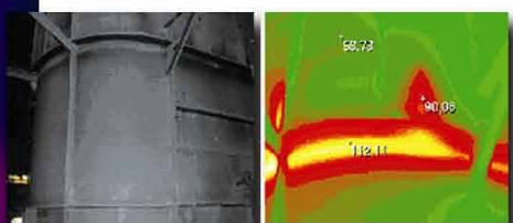
Видимое и тепловое изображение печи
