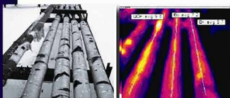
Видимое и тепловое изображение магистрального трубопровода
