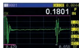
Накип (труби котла)
